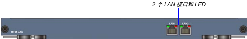
图 1-13 RMX 4000 RTM LAN 后面板布局
